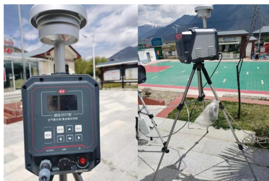
图4 大气微塑料主动采样器
