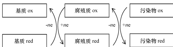
图 3 腐殖质介导的污染物还原示意图 [21]
