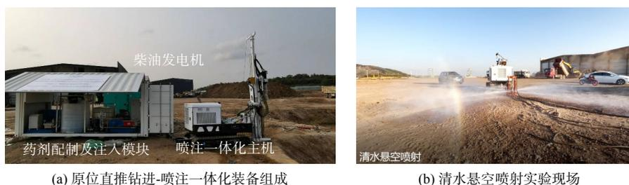
图 1 原位直推钻进-喷注一体化装备实验装置
