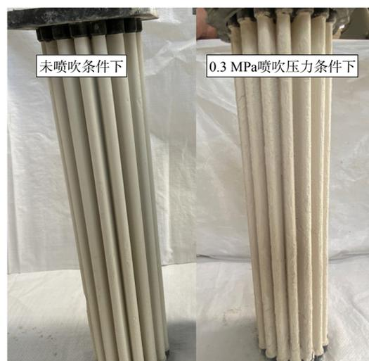
图 7 有无脉冲压力滤筒附粉情况对比图
