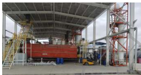
图 2 油页岩间接加热回转窑热解成套设备现场图
