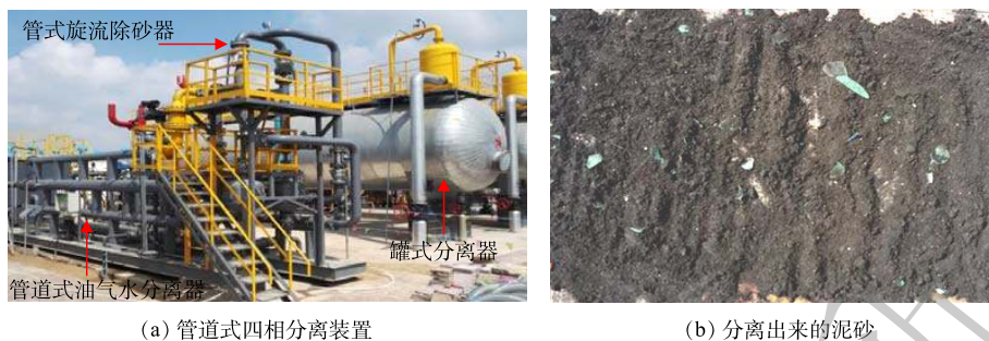
图 9 管道式油气水砂分离装置及分离出的泥砂
