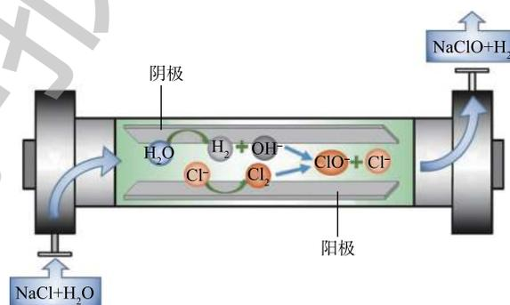
图1 次氯酸钠发生器的工作原理
