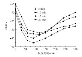
图 8 前置曝气时间对 R1 中 Eh 的影响 Fig. 8 Influence of pre-aeration time on Eh in R1
