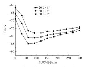
图 5 前置曝气量对 R1 中 Eh 的影响 Fig. 5 Effect of pre-aeration on Eh in R1
