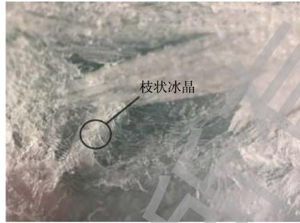
(反应条件: 温度为  $-18\ ^\circ\text{C}$ ; 初始盐浓度为  $8\ 000\ \text{mg}\cdot\text{L}^{-1}$ ; 初始 COD 为  $2\ 000.0\ \text{mg}\cdot\text{L}^{-1}$ )
