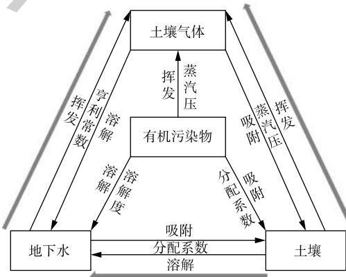
图2 有机污染土壤内物质输运过程示意图
